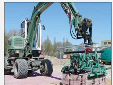
Für größere Bagger ist der Pflastergreif P02-3 das geeignete Gerät
